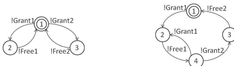
FIG. 4.5 – Exemples de politique d'arbitrage de bus
